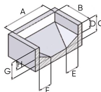
Les rayons horizontaux doivent être inférieurs ou égaux à 15 cm, les pans coupés inférieurs ou égaux à 10 cm.
